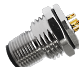
M12 公头面板式，焊接式，前锁安装
