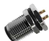
M12 公头面板式，焊接式，前锁安装
