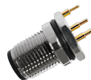
M12 公头面板式，PCB型，前锁安装，屏蔽针
