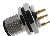
M12 公头面板式，PCB型，后锁安装，屏蔽针
